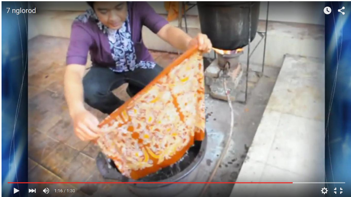
Gambar 92: Tampilan Demostrasi Proses Pencucian Kain Batik Setelah Dilorod dengan Menggunakan Air Bersih
